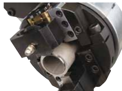
Moduli di taglio a rulli per taglio FME
