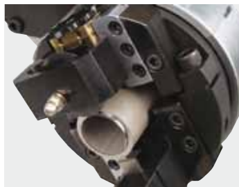
Trennschneidmodul mit Rollenabschneider für FME-Schneiden.
