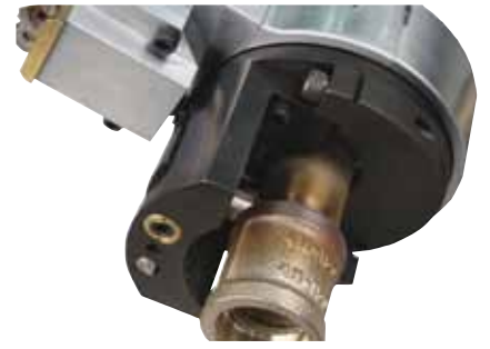
Werkzeugschlitten zum axialen Trennen von Muffenschweißnähten
