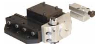
Slitte elicoidali per tubi con spessori elevati, da 70 mm circa di spessore parete
