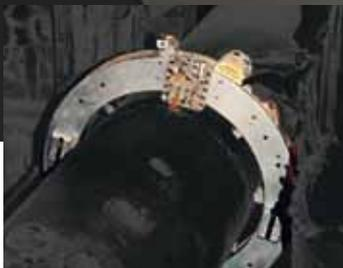
Alle "Low Clearance Split Frames" sind tragbar und in engsten Platzverhältnissen einsetzbar.
