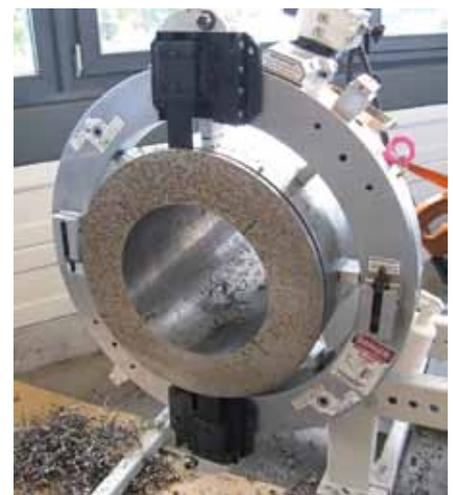
LCSF mit Hochleistungswerkzeugschlitten-Baugruppe
