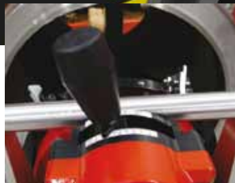
Automatischer Vorschub durch "SpeedPrep".
