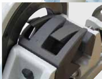
Serraggio anti-deformazione di tubi di piccolo spessore
