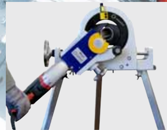
Trennen dünnwandiger Edelstahlrohre und Rohrbögen
