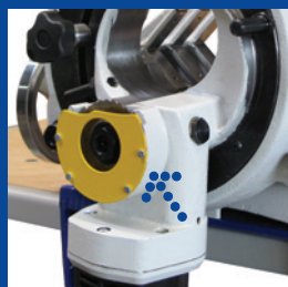
Дополнительное крепление пыльных полотен для отделения колен труб.
