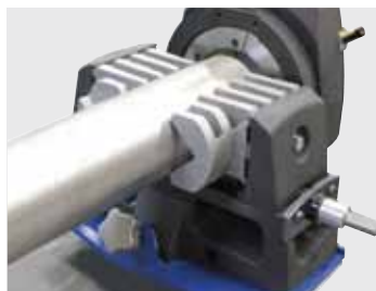
高标准的固定夹或碗装固定夹可防止管子变形和腐蚀 (21页)
