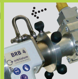
Крепление для сбалансированного манипулятора обеспечивает быструю и не требующую усилий обработку.
