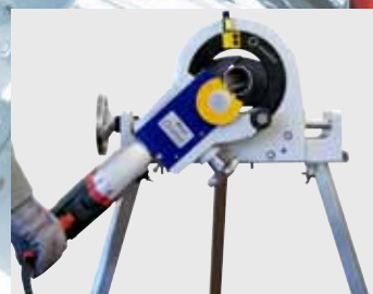
K dělení tenkostěnných trubek a odřezávání trubkových kolen
