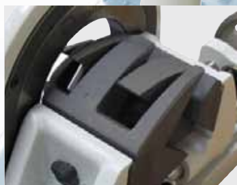
Upínání tenkostěnných trubek bez vzniku deformace
