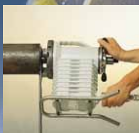
Integrovaná rukojeť umožňuje rychlé dosazení do trubky.
