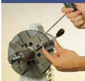
Systém rychlé výměny nástrojů QTC® (Quick-Tool-Change).
