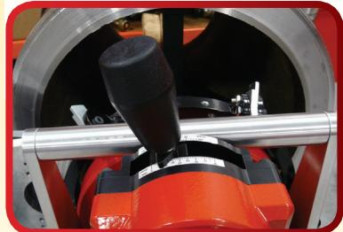
Automatický posuv nastaviteľný pomocou ovládacej páčky
