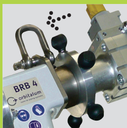
Závesné oko umožňuje použiť vyvažovač a tým i rýchlu a neunavujúcu prácu.
