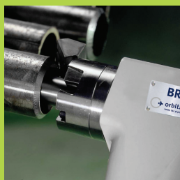
Precízna a opakovateľná príprava pre zvar pre spájanie trubiek a trubiek s trubkovnicou.
