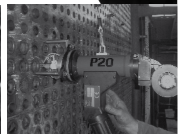
Einfache Handhabung bei maximaler Funktionsvielfalt. Präzise Zentrierung mittels auswechselbaren Zentrierpatronen.
