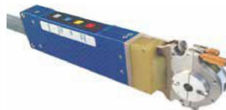
OW 12 с широким зажимным патроном (версия В) и сменные зажимные втулки
