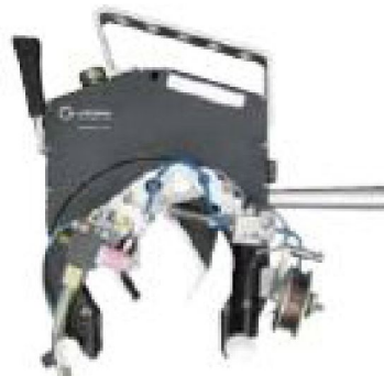
ORBIWELD TP 400 с KD 3-62 и подачей проволоки без тока
