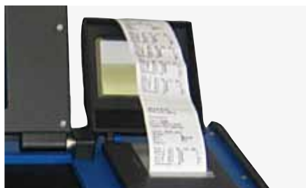
Mini stampante integrata per la stampa dei dati di saldatura e programmi
