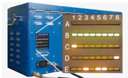
PSS Pro-Service-System: Diagnostica a led per una semplice e veloce verifica dei segnali di errore
