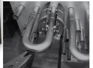
Posizionamento veloce e semplice sui tubi per mezzo della pinza di fissaggio.
