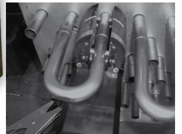
Montage simple et rapide de la tête de soudage sur le tube. Tête de soudage auto-stabilisée.
