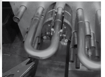
Einfache und schnelle Montage der Schweißzange auf dem Rohr. Selbsthaltender Schweißkopf.
