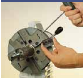
刀具快速夹紧系统 QTC® (Quick-Tool-Change).
