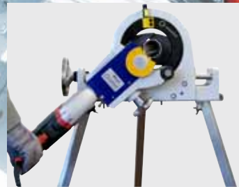
Pour tronçonner des tubes à parois fines et des coudes
